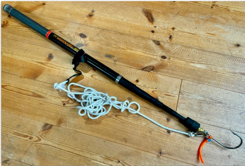
Eigenbau-Teleskop-Gaff aus 5,40 m Stiel, Hai-Haken, Gewinde und Sicherungsschnur
